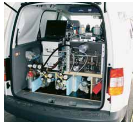
2: Mobile Kalibrieranlage im Fahrzeug: Im Vordergrund rechts ist der Partikelgenerator CAST zu erkennen.
